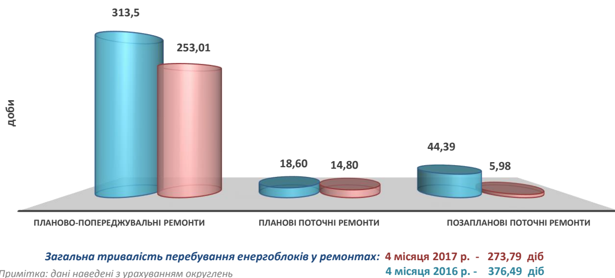
Рис. 4. Тривалість перебування енергоблоків АЕС у ремонтах
